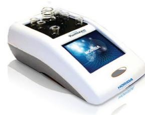
Analyseur compact à 2 canaux dédié aux petits laboratoires pour les tests de dépistage en hémostase et les D-Dimères
