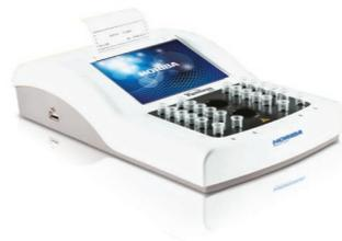
Analyseur compact à 4 canaux dédié aux petits laboratoires pour le dépistage en hémostase et les tests spécialisés
